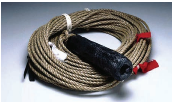
Тросовый лот. Использован в 1959 г. Отмечена глубина озера – 1620 м
